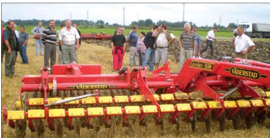
Vučeni Carrier dolazi u radnim širinama od od 4,2 do 12,25 m dok je transportna širina svih izvedbi 2,5 m
