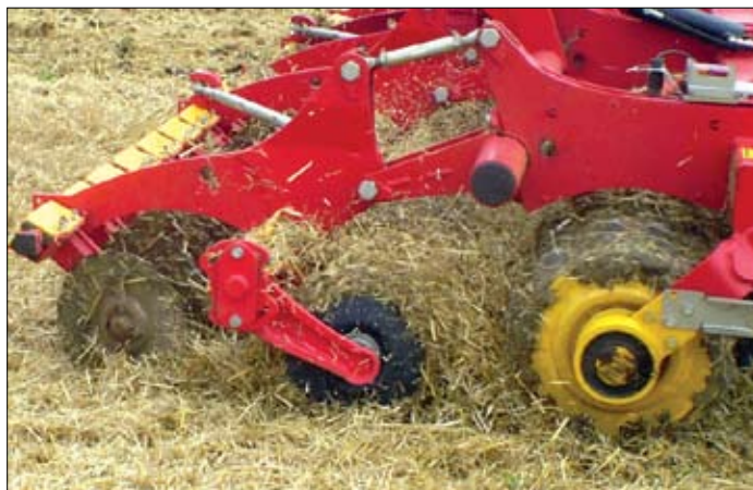
Carrier 650 – vučena kratka tanjurača čija je osnovna namjena prašenje strništa ali i priprema tla za sjetvu
