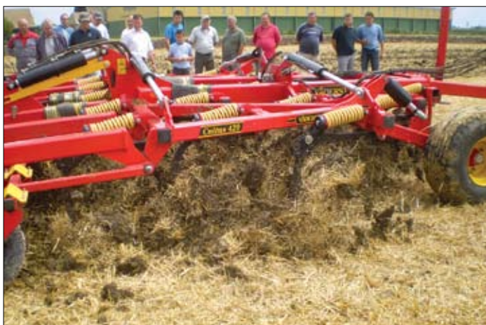
Nakon obrade do 25 cm dubine tlo ostavljeno iza ostaje rahlo, ravno i spremno za sjetvu ili daljnju obradu
