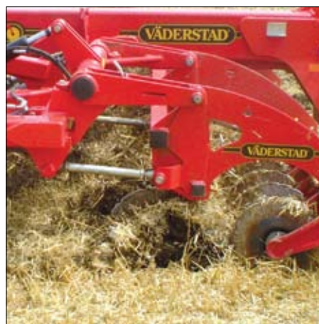
Prednji red 450 mm koničnih diskova radi najbolje pri brzinama od 10-15 km/h
