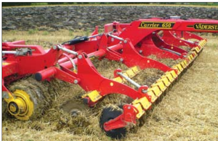
Carrier je prezentiran u plitkom radu na dubini do 5 što je dovoljno kako bi se isprovocirali korovi
