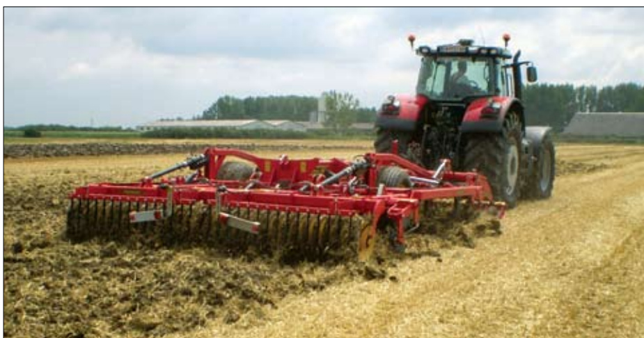
TopDown dolazi u radnim širinama od 3 do 9 m a u radu je prikazan uređaj 4 m radne širine
