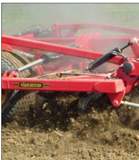
Pero reže vertikalni prozračni kanal od površine prema dubljim slojevima tla
