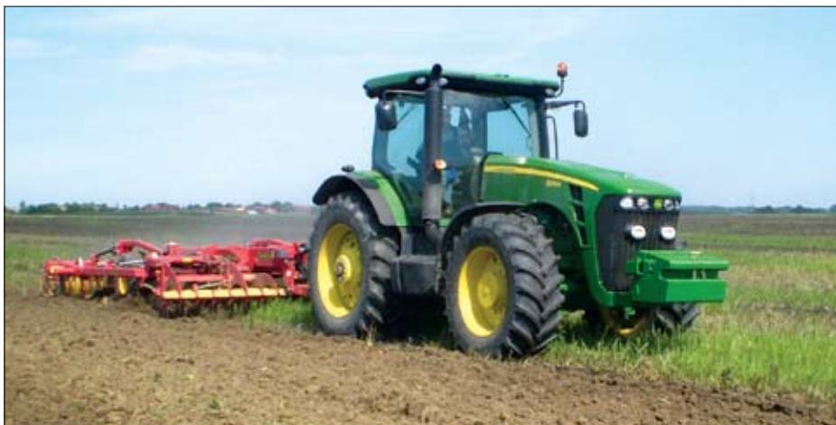
Diskovi su proizvedeni od veoma čvrstog „V-55“ materijala te su montirani uz gumene suspenzije na nosačima. Kombinacija tih stvari daje jako dug vijek trajanja te i veoma niske troškove održavanja
