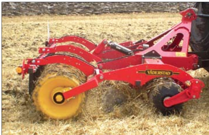
Carrier 300 450 mm diskovi te čelični ili packer valjak ovisno o tipu tla koji se obrađuje
