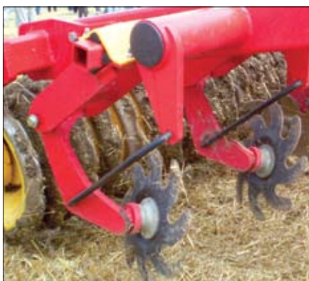
Stražnji diskovi na TopDownu poravnavaju brazde ukoliko ih ostavlja zadnji red pera
