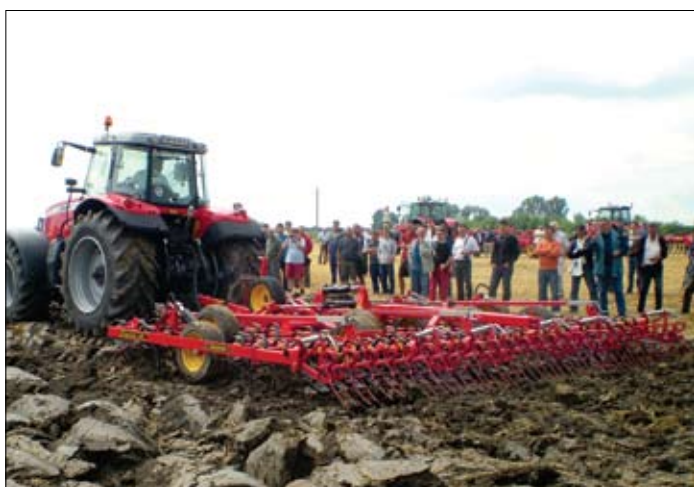
NZ Aggressive dolazi u radnim širinama od 4 do 10 m
