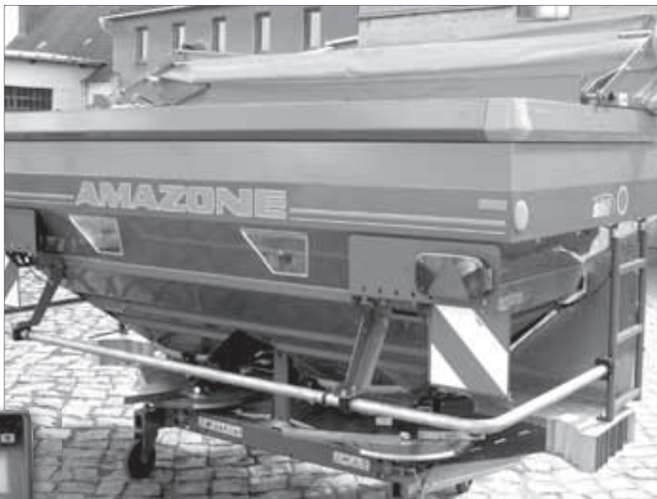
Radni dijelovi su svi od inoxa a najveća vrlina ovoga rasipača je SBS sistem rasipanja
