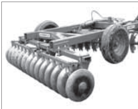
Tanjurače tipa "Kupa" namijenjene su za grubu dopunsku pripremu tla, za agregativno radnje traktorima 66-95/90-130 kW/KS
