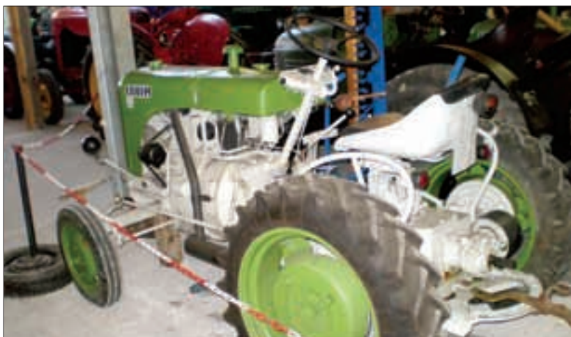
Steyr iz 1952. godine, tip 80, imao je jedan cilindar i vozio 16 km/h
