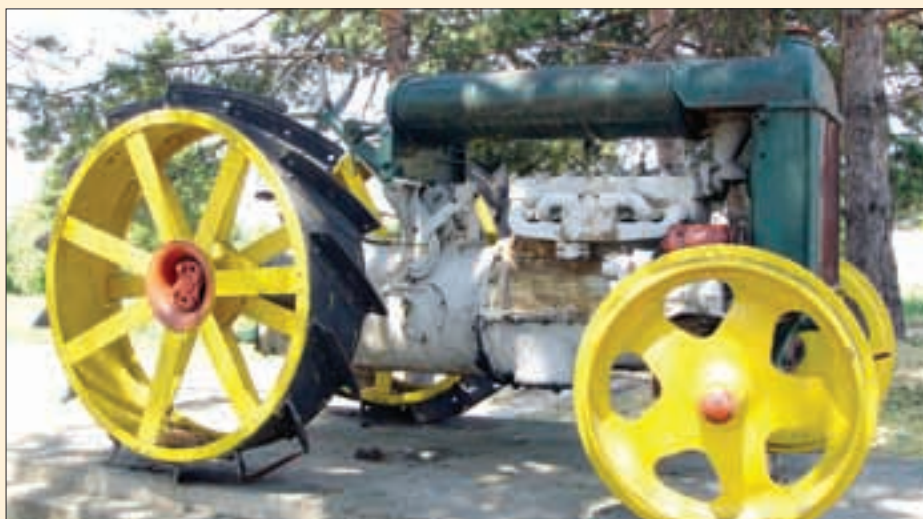
Henry Ford 1917. predstavlja Fordson - prvi masovno proizvedeni traktor. Izrađivao se u SAD-u, Irskoj, Engleskoj i Rusiji do 1923. zauzima 77% tržišta unutar SAD-a
