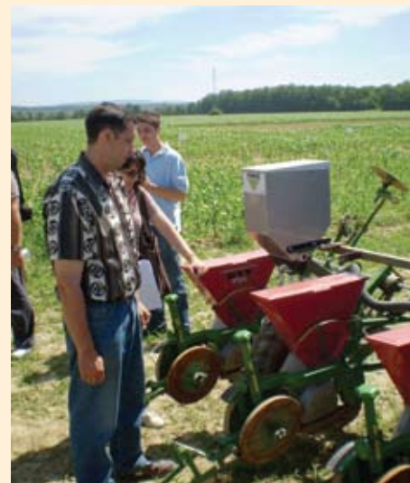
Ugrađeni depozator za Force na sijačici OLT PSK
