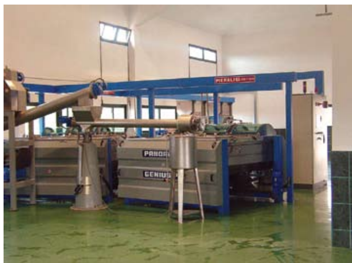
Uljara Bilaja, Najevo. Najsuvremenije tehnološko rješenje PANO-RAMA P6 GENIUS (dvije autonomne linije P3), Procesom upravlja računalo. Prerada se može vizualno pratiti, a moguća je kontinuirana kao i odvojena istovremena prerada maslina više različitih vlasnika. Instalirani kapacitet: 60-65 tona maslina na dan, dosad najveći instalirani kapacitet u Republici Hrvatskoj
