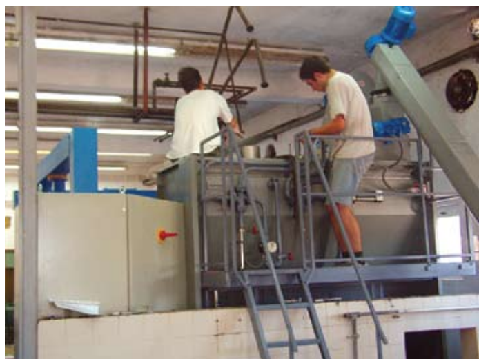
Uljara "Blato 1902 d.d. Prese "Verachi", 3 komada; + FP/3 + dekanter "Super 1", 2 komada. Kombinirano postrojenje: tradicionalni način prerade prešanjem i kontinuirani dekanterški sistem (prva generacija dekantera). Instalirani kapacitet: cca 2900 kg maslina na sat
